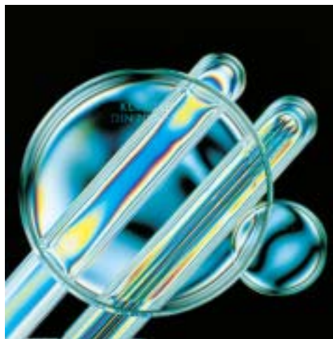
Imaginea optică în lumină polarizată a sticlelor de nivel lungi și circulare pretensionate termic
